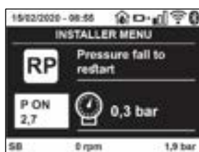
18.ábra: az újraindítási nyomás beállítása
