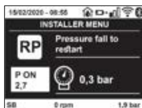
Figura 18 Réglage de la pression de redémarrage
