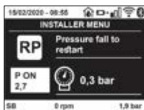
Рисунок 18 Настройка давления нового включения
