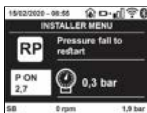
Figura 18: Programação da pressão de rearranque
