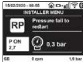
الشكل 16 ضبط ضغط إعادة التشغيل
