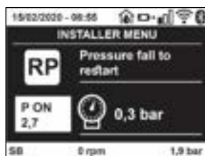
Rysunek 18: Ustawienie wartości ciśnienia uruchamiania
