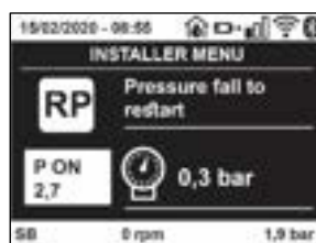
Figura 18 Configuración de la presión de reencendido
