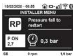
Obr. 18 Nastavení tlaku znovuspuštění
