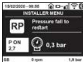
Abbildung 18 Einstellung des Neustartdrucks
